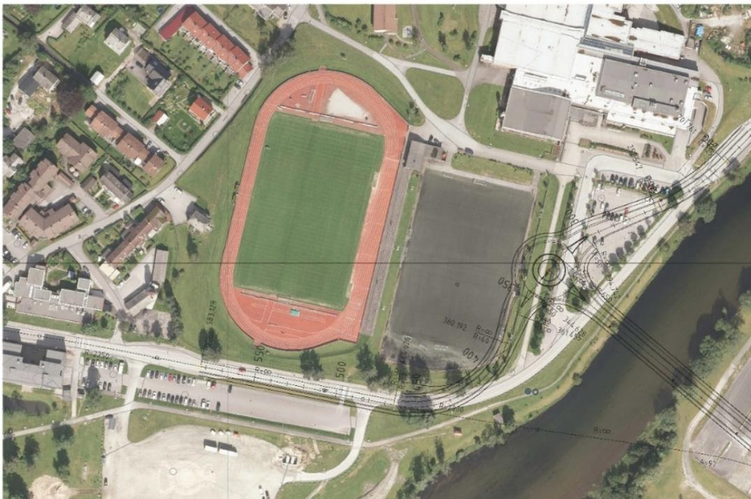
*Alternativ 1: Prinsippskisse av kort brukryssing, og rundkøyning som kryssløysing med Angedalsvegen*
